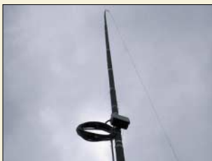
Loop-Antennen für das 40-m-Band, hier der Speisepunkt bei vertikaler Polarisation, versprechen guten Wirkungsgrad für DX-Verbindungen. Foto: DL2RD
