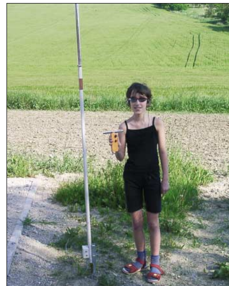
80-m-Fuchsjagdset: Links der in die Antenne integrierte Sender, rechts der Empfänger. Foto: DL2AVH
