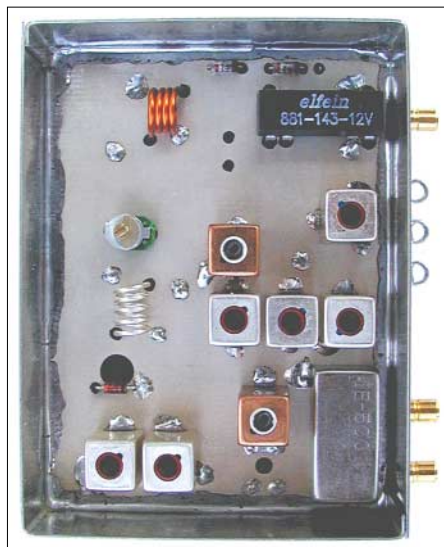
Bild 7: Oberseite des fertig bestückten Frontends im Weißblechgehäuse
