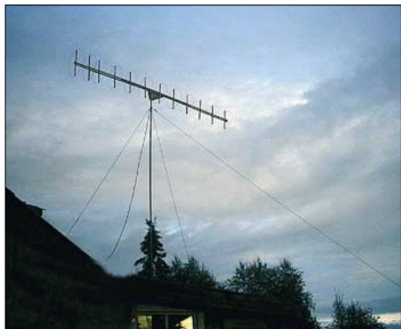
12-Element-Antenne von RZ1ZZZ/p – die Murmansk-Klubstation aktivierte zu den Perseiden das seltene Mittelfeld KP76EQ in WSJT und war gefragter QSO-Partner.
